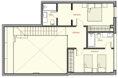
portal **1** - vivienda **C** superficies CONSTRUIDAS subtotal PLANTA BAJA subtotal ENTREPLANTA total CONSTRUIDA VIVIENDA 62,21 46,29 108,50 m<sup>2</sup>
